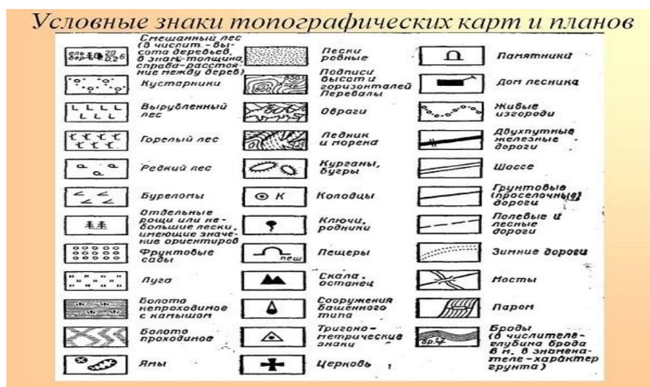
Рис. 1. Условные знаки плана местности и топографических карт
